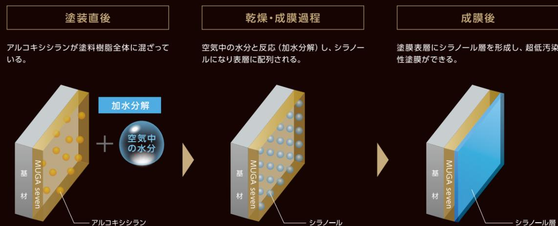
シラノールとはアルコキシシランを加水分解して得られる親水性を発揮する化合物です。表層が変成したその塗膜は付着した汚染物質をハイドロクリーニング効果により雨水が流し落とします。また、静電気の帯電も少なくチリやホコリを寄せ付けず、建物の美しさを長期にわたり保ち続けます。
